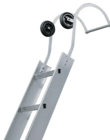
Stahlbügel, verzinkt, mit 2 Laufrädern. Die Dachleiter wird mit dem montierten Firsthaken auf der Dachfläche zum First gerollt, dort umgedreht und am First eingehängt.
