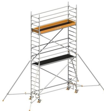
**Gewicht:** 232.1 kg**Gerüsthöhe:** 5,43 m**Arbeitshöhe:** 6,20 m**Kategorie:** Rollgerüst**Standhöhe:** 4,20 m**Material:** Aluminium**Plattformbreite:** 0,75 m**Plattformlänge:** 2,85 m**gpsr\_manufacturer\_homepage:**
